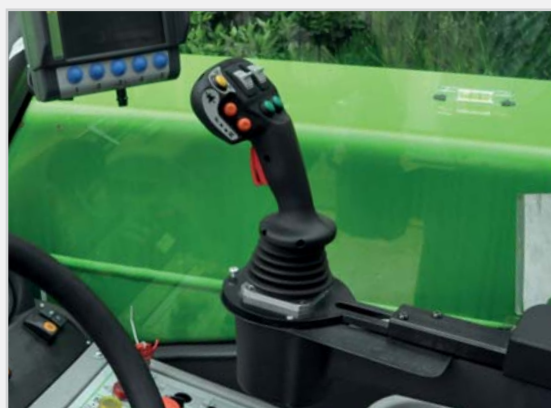
HM: loketní opěrka a joystick s ovládáním směru jízdy
