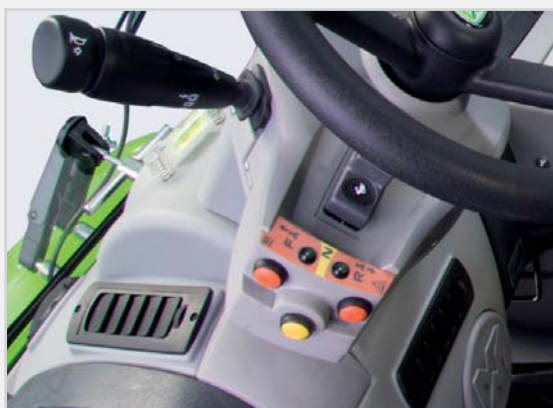
HM: ovládání směru jízdy na sloupku volantu
