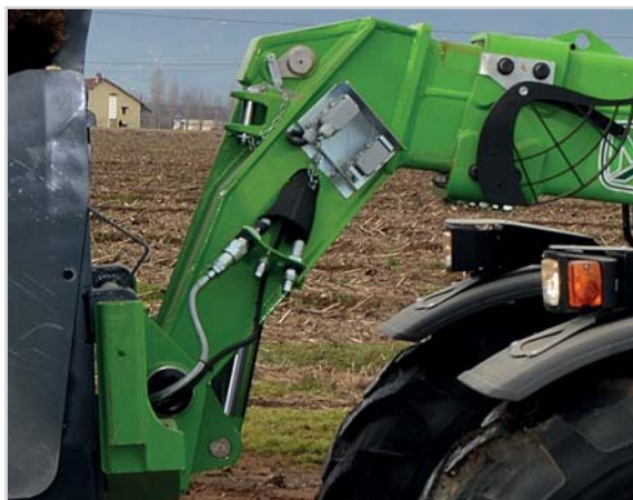
Trubky, elektrické kabely a hydraulická vedení umístěné uvnitř ramene
